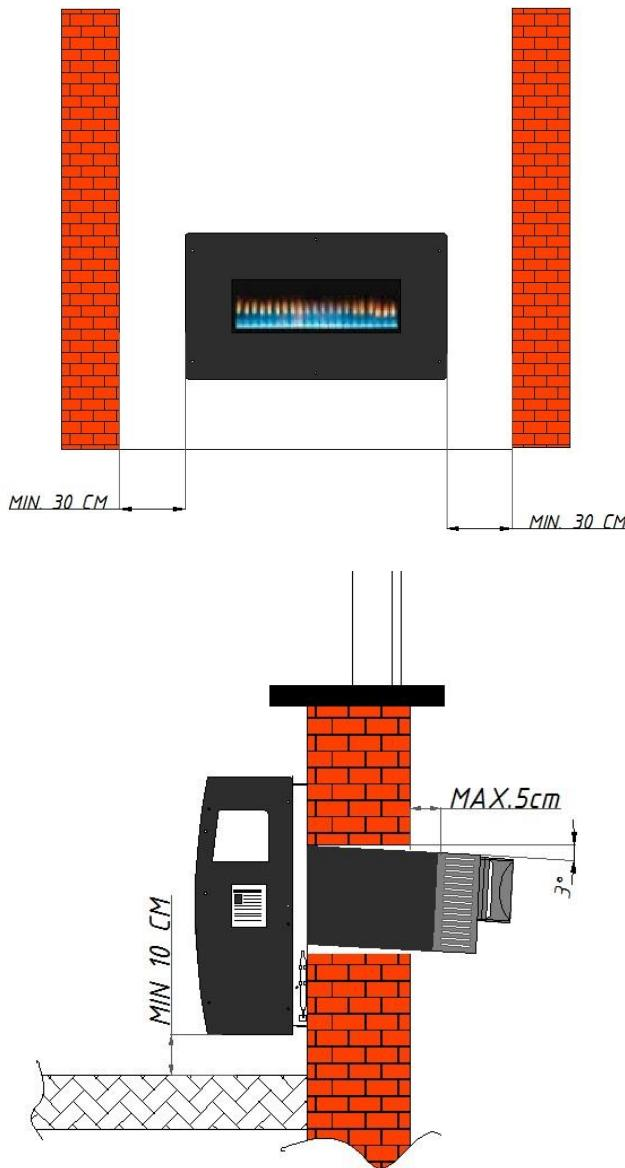
Рисунок-5: Схема монтажа конвектора HP/HS
